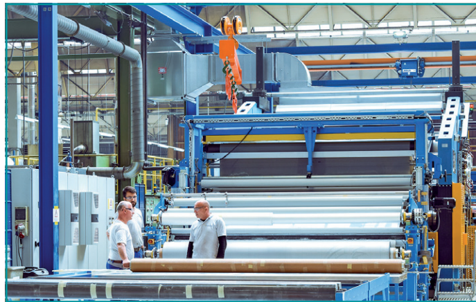
Nahtlose Dichtungsplatten bis 3,2 m Durchmesser mit der Rotocure D320. Foto: Steinbach AG
